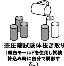
※圧縮試験体抜き取り (紙缶モールドを使用し試験持込み時に自分で脱形する。)
